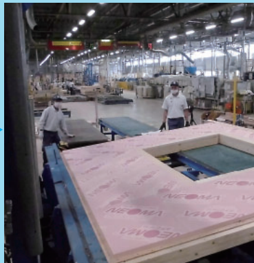
データをもとに 木造大型パネルを製造
